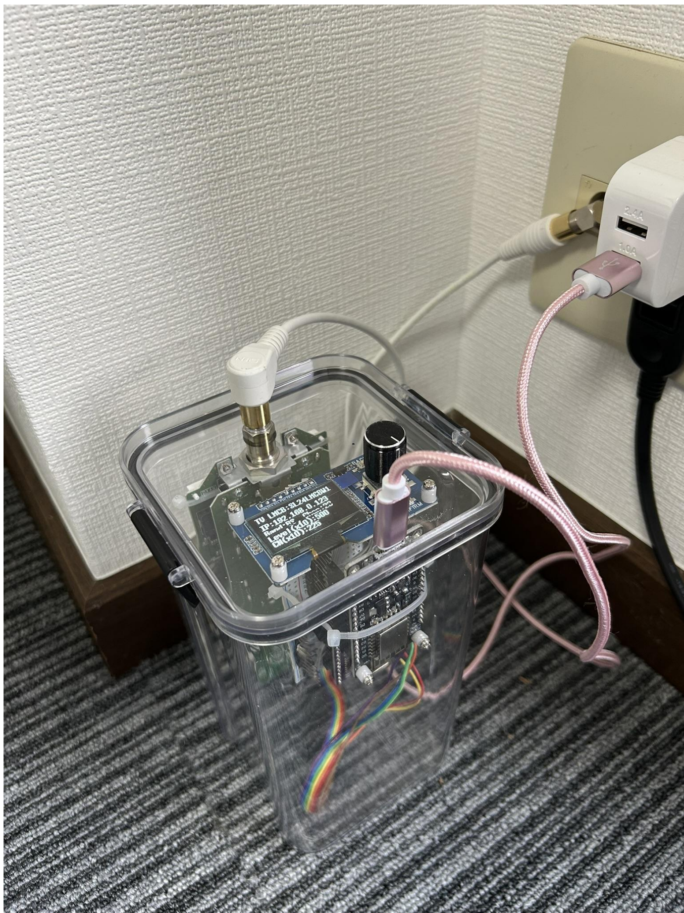
壁面テレビ端子に接続した計測端末
